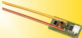
**Platine mit zwei LEDs für Hausbeleuchtung:**
